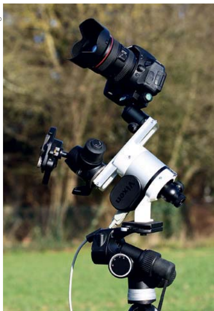
▲ Abb. 3: Die kleine Montierung für unterwegs: AP Star Tracker. An der mitgelieferten Schiene können bis zu vier Kugelköpfe für die Aufnahme von Kameras montiert werden.
